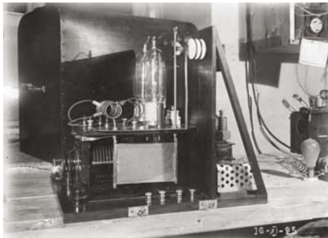
Конструкция коротковолнового передатчика Нижегородской радиолaborатории
