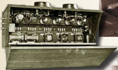
Ламповый КВ усилитель разработки В.М. Петрова
