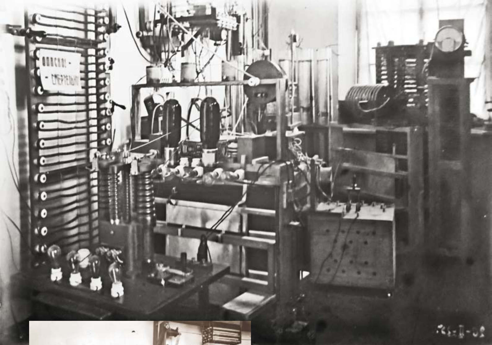
Коротковолновый передатчик (нижегородская установка) с лампой 25 кВт конструкции М.А. Бонч-Бруевича
