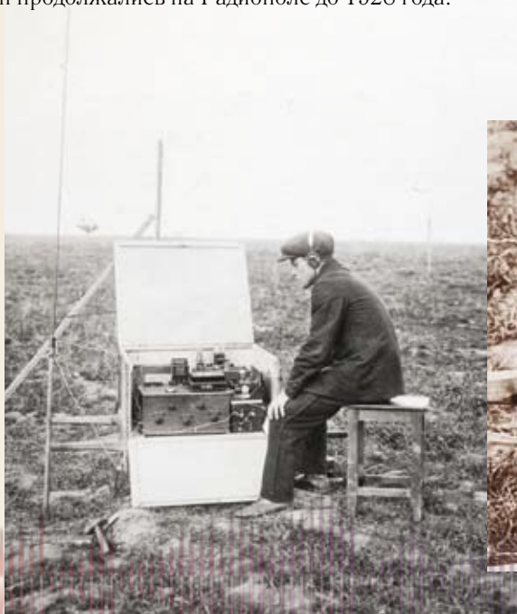
Радиополе НРЛ. Исследование направленности антенн
