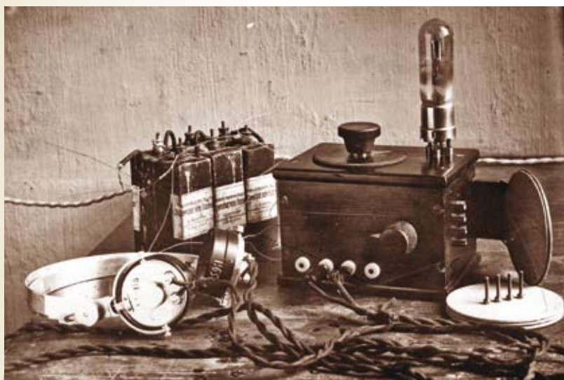
Одна из моделей микродина конструкции Б.Л. Максимовых. 1924 год
